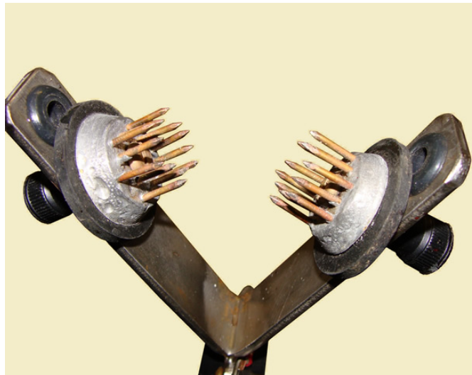
手持式电击致昏设备的接触电极。
