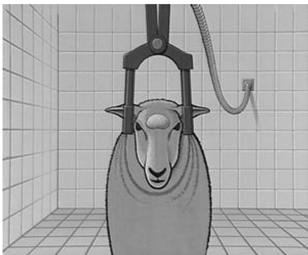
Рисунок 7. расположение электродов для овец (вид спереди)
