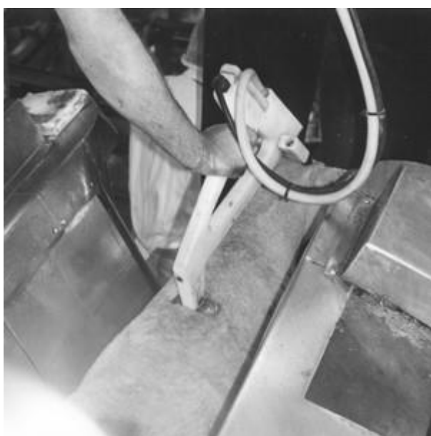
Рисунок 14. Правильное расположение заднего электрода
